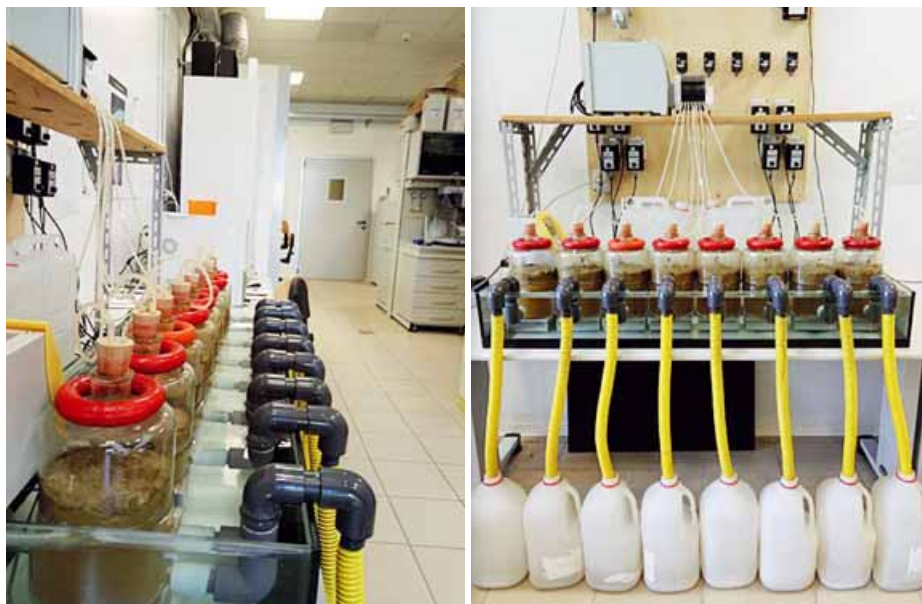
Foto 1 Impianto sperimentale di fermentatori continui per la produzione di liquido di fermentazione ruminale
