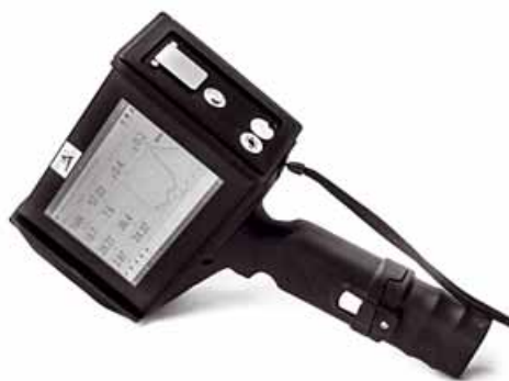
Foto 1 Strumentazione Nirs portatile e semplici metodiche analitiche per valutare le caratteristiche chimiche e il comportamento ruminale dei foraggi
